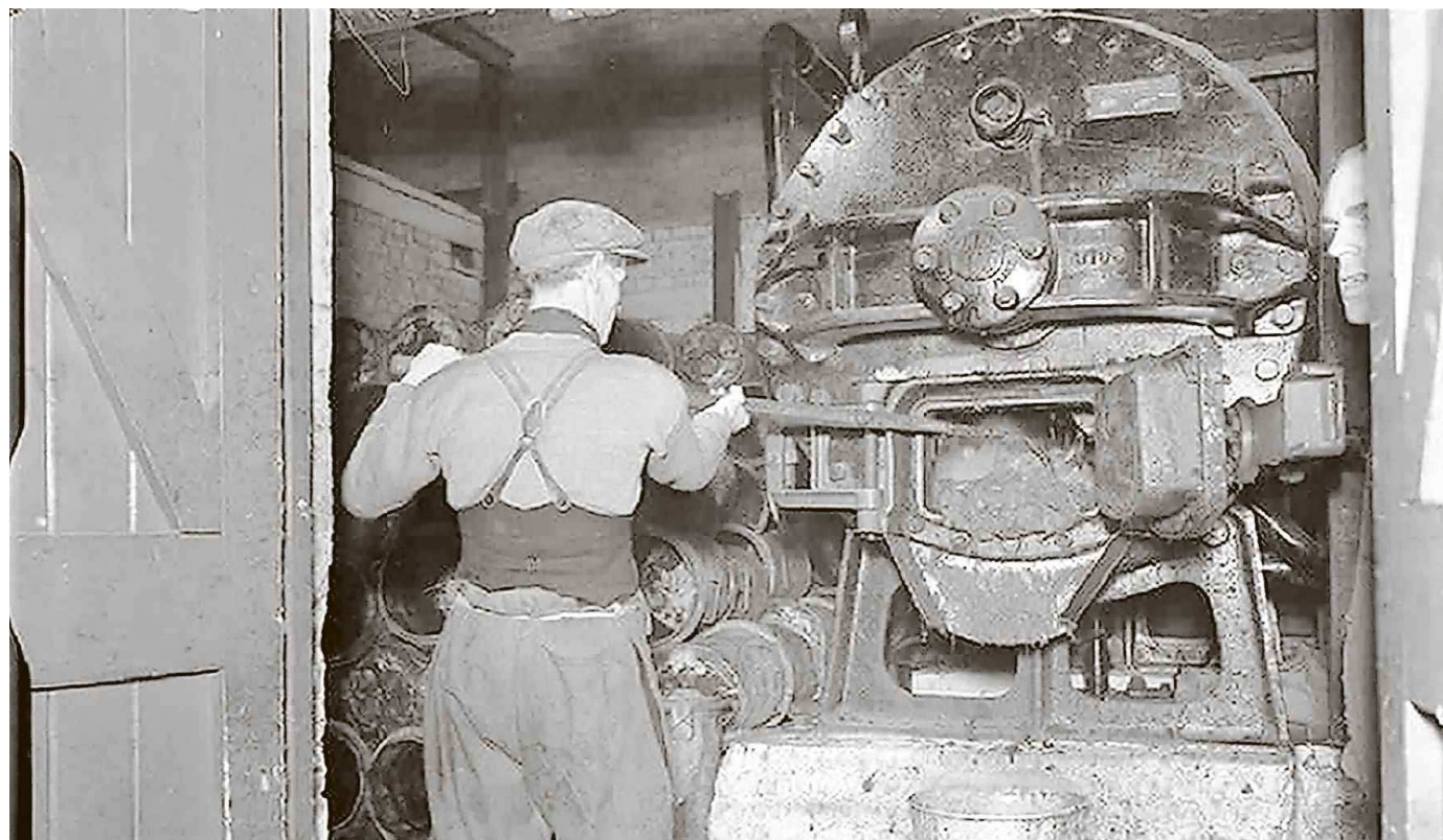
Het lossen van het diermeel uit de destructie-autoclaaf was vroeger handmatig werk. Bron: Animal rendering
